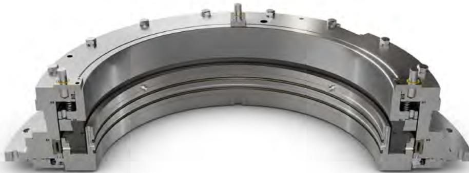
Los sellos de tipo axial se usan, normalmente, en centrales hidroeléctricas e instalaciones municipales, en turbinas y bombas donde prevalecen presiones más altas y condiciones más robustas. Su propósito principal es mantener un sello hermético cerca del agua entre el eje y la tapa del cabezal de la unidad.
